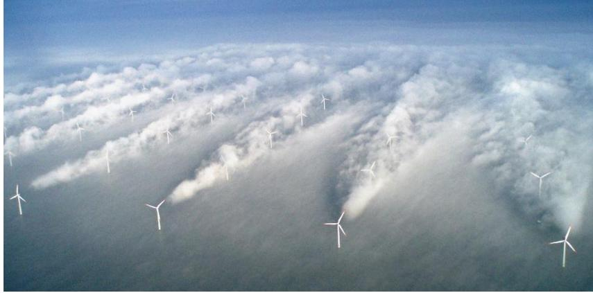
Yukarıda bahsi geçen iz etkisini azaltmak ve ayrıca optimum kablolama uzunluğu için planlama ve kablolama maliyetlerinin azaltılması ve kablo bağlantı kaynaklı kayıpları minimuma indirmek için çok sayıda optimizasyon çalışması halen yapılmaktadır.
